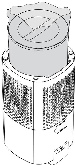
4. Entfernen Sie die Verpackung des Filters und setzen Sie ihn in den Luftreiniger ein.
