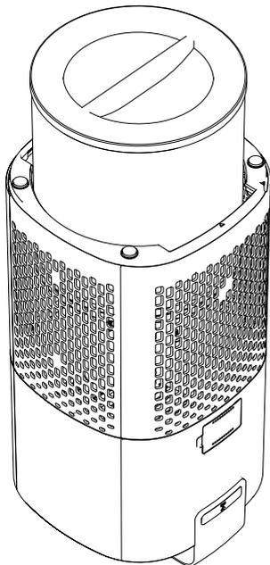
4. Nehmen Sie den neuen Filter aus seiner Verpackung. Setzen Sie den neuen Filter in den Luftreiniger ein.
